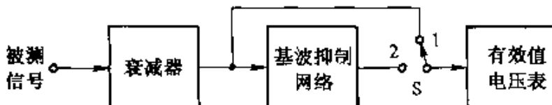
图 1.5.1 基波抑制法原理图
