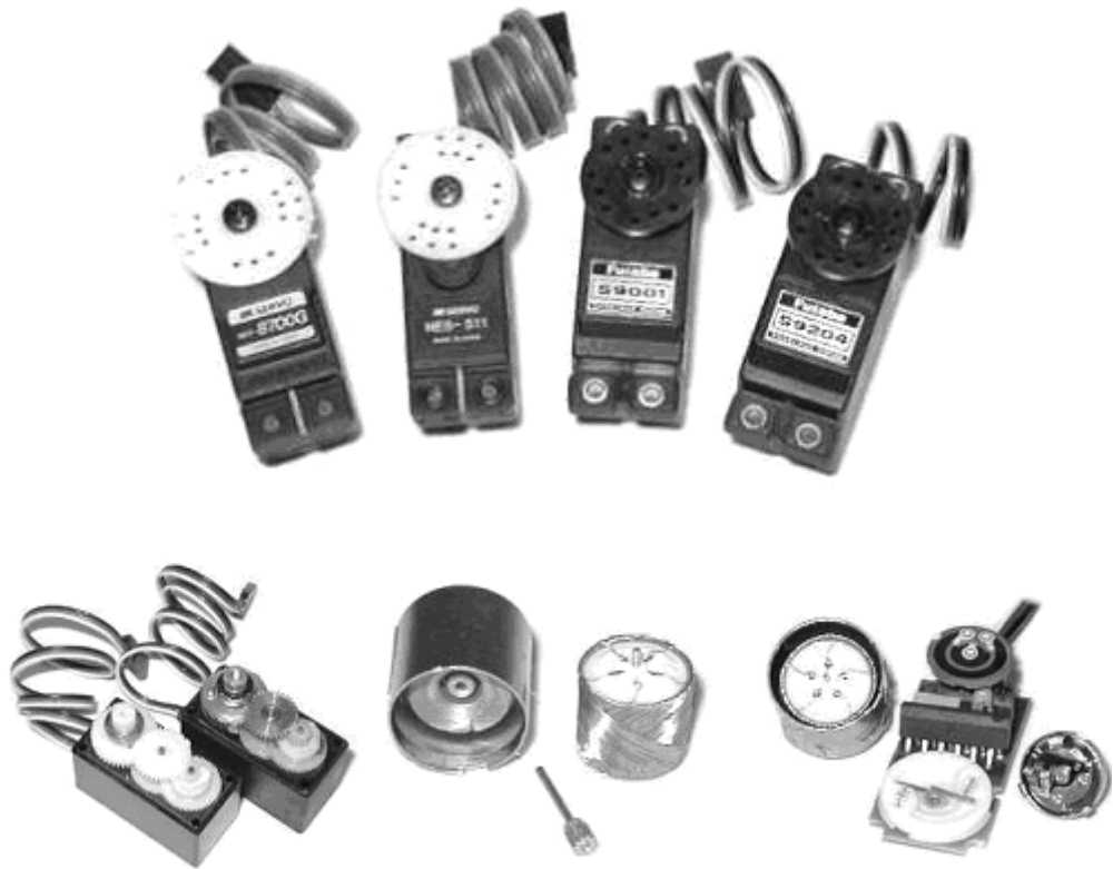
图 2.3.24 各种舵机及分解实物
