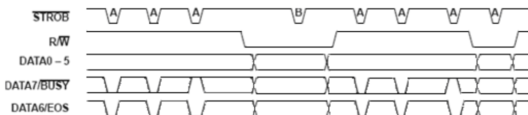
图 4.2.3 MSP53C392 与微控制器的接口的操作时序
