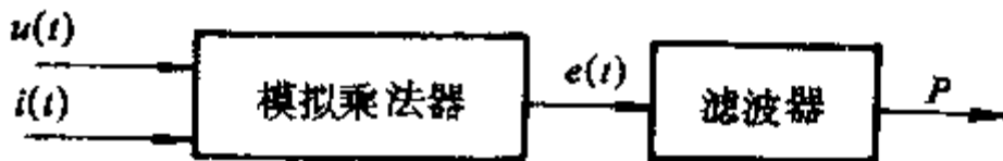
图 1.2.38 功率变换器的原理框图
