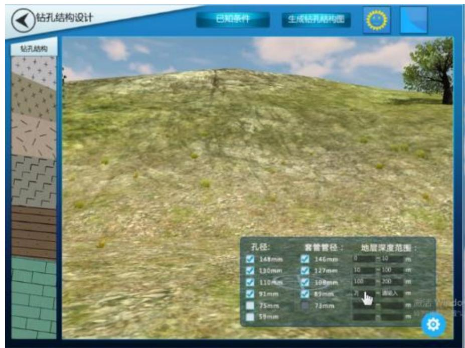
图 2-51 钻探孔径与套管级配关系展示
