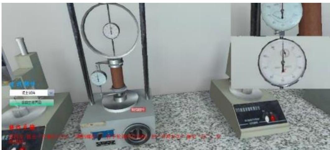
图 2-26 土的无侧限抗压强度虚拟实验 (2)
