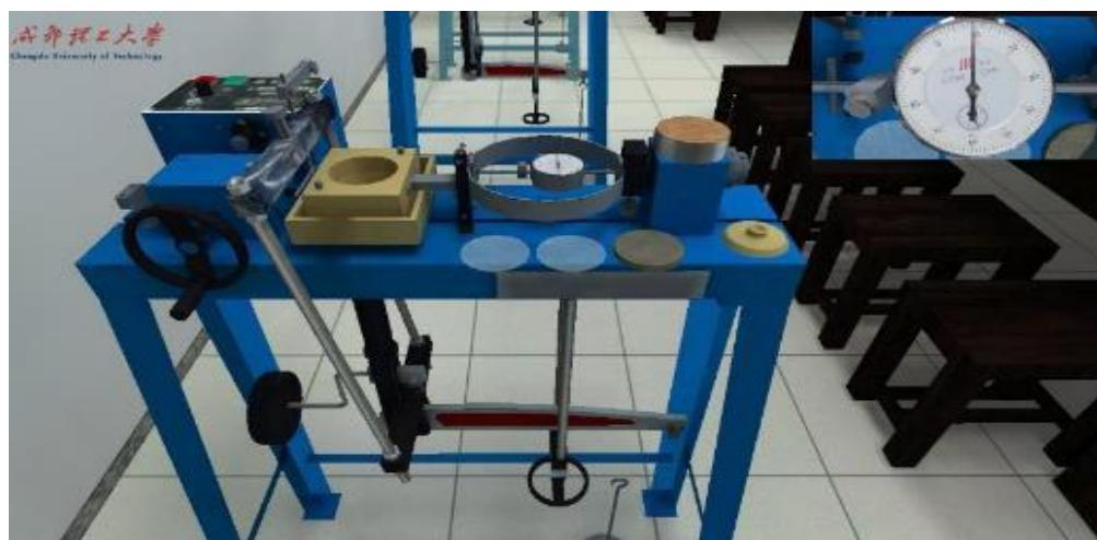
图 2 - 19 土的直接剪切虚拟试验（快剪）(1)
