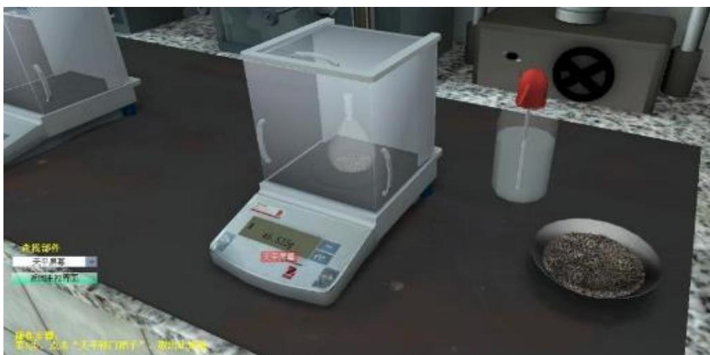
图 2-10 土粒比重虚拟实验（比重瓶法）(2)
