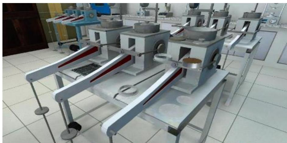
图 2-17 土的标准固结虚拟实验（1）
