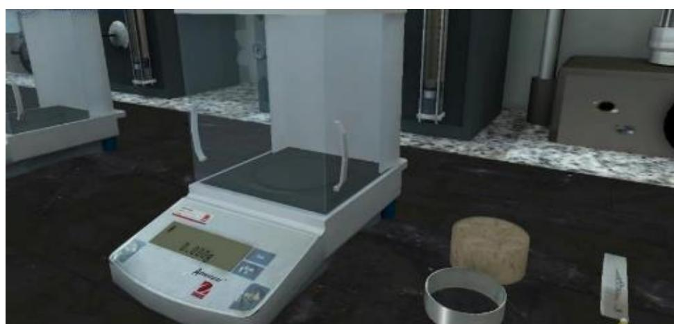
图 2-11 土的密度（环刀法）虚拟实验 (1)
