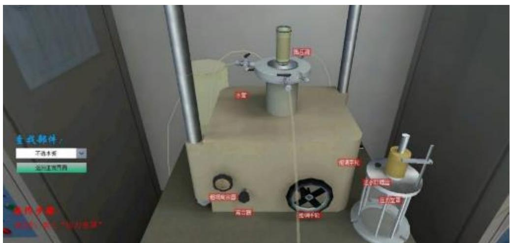
图 2-24 土的三轴压缩虚拟实验（不固结不排水）(2)
