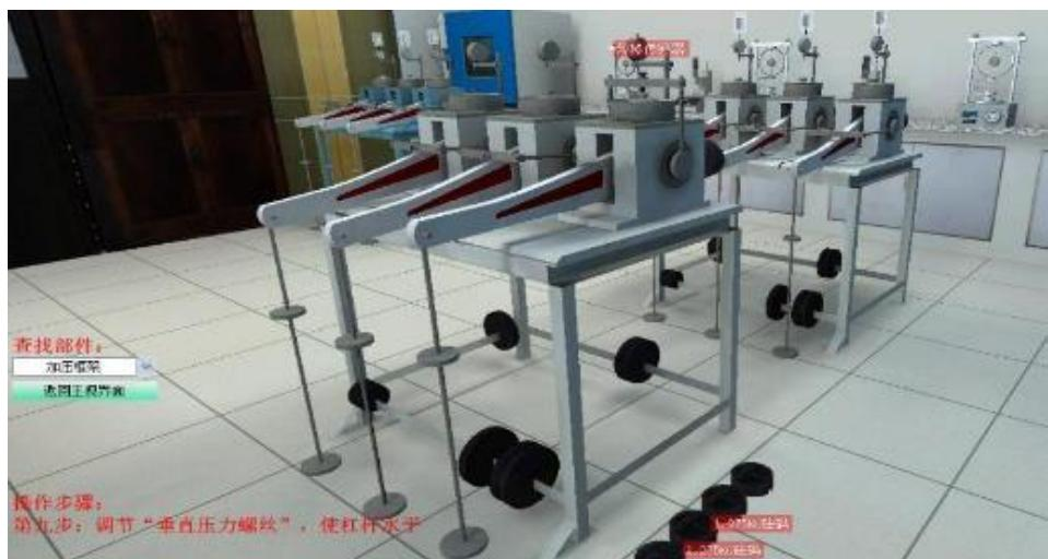
图 2 - 18 土的标准固结虚拟实验（2）
