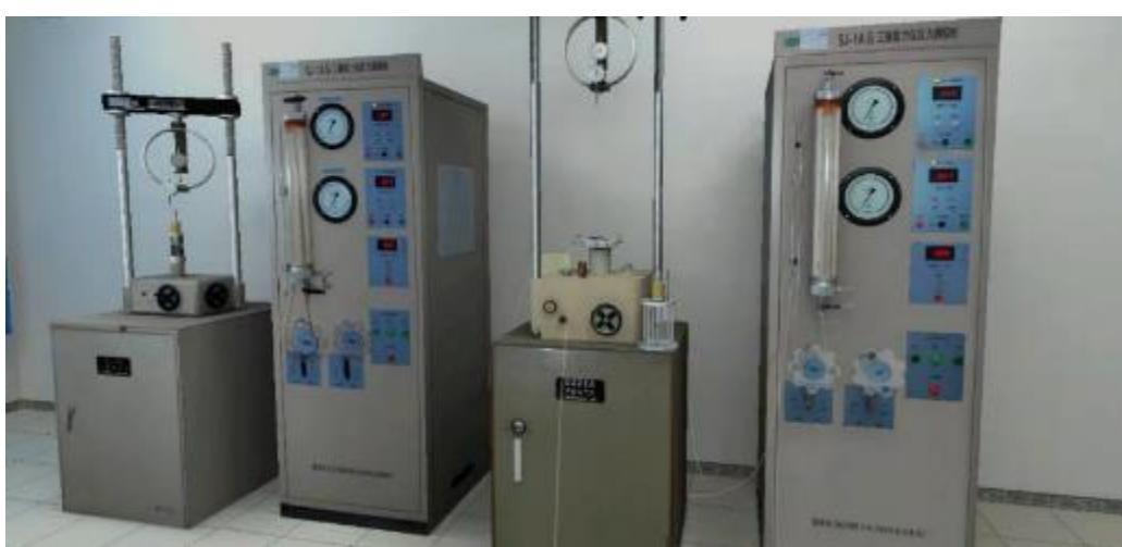
图 2-23 土的三轴压缩虚拟实验（不固结不排水）(1)
