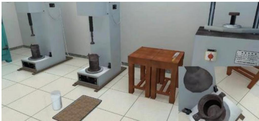
图 2-21 土的击实虚拟实验 (1)
