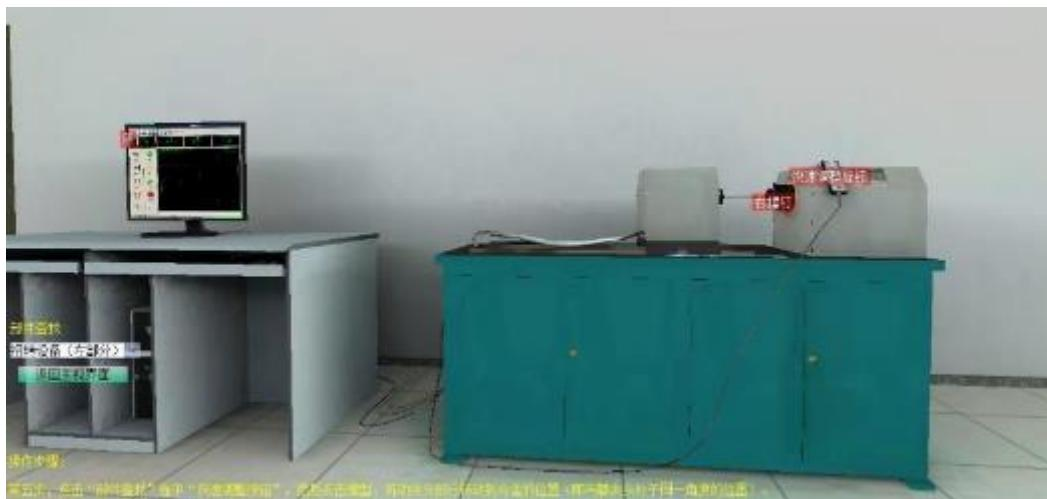
图 2-8 低碳钢和铸铁的扭转虚拟实验 (2)
