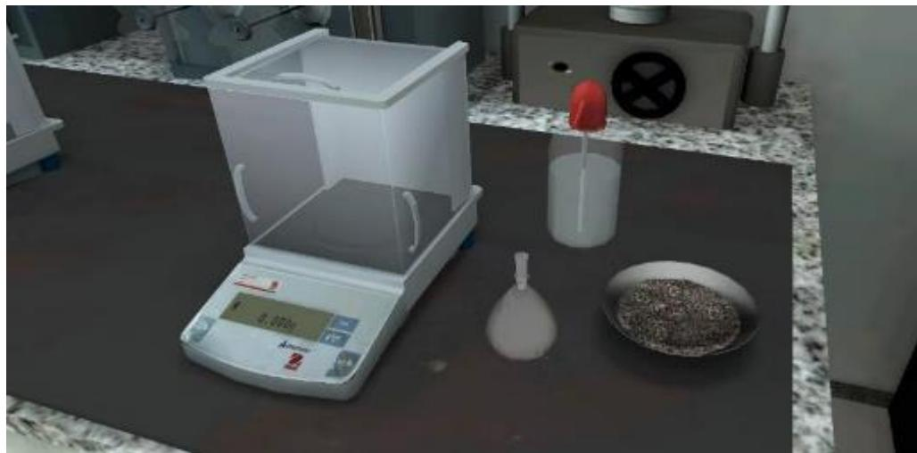
图 2-9 土粒比重虚拟实验（比重瓶法）(1)
