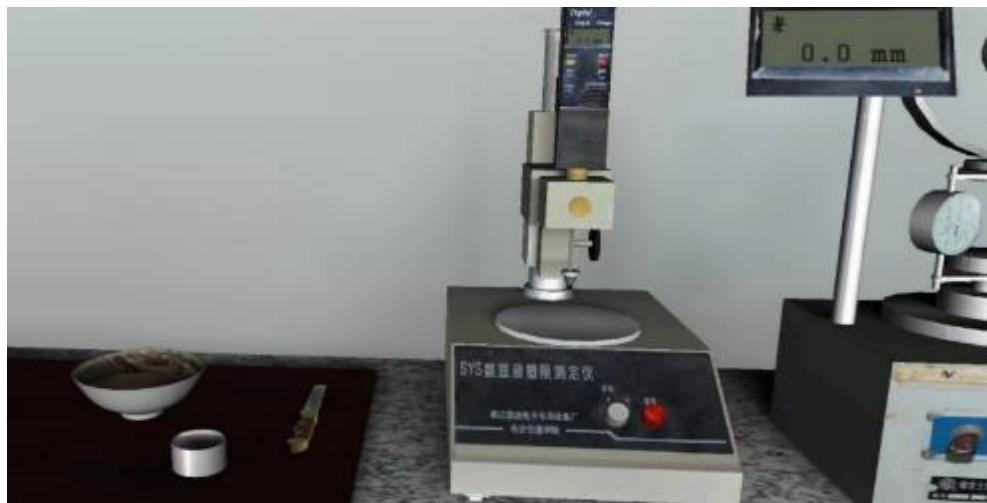
图 2-13 土的界限含水率（液、塑限联合测定法）虚拟实验（1）
