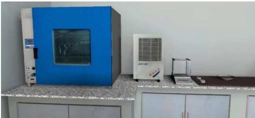
图 2-15 土的含水率（烘干法）虚拟实验（1）
