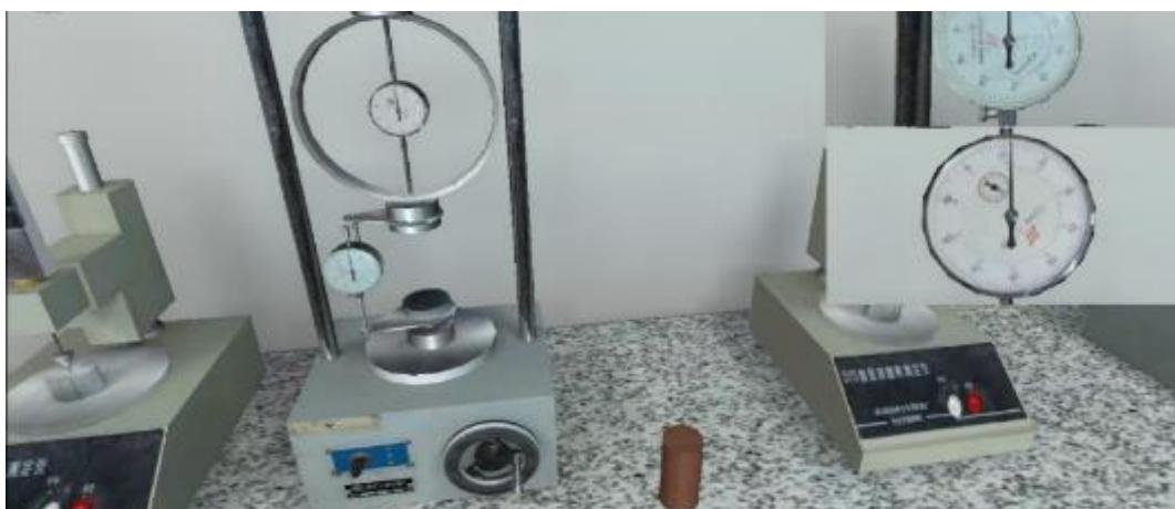
图 2-25 土的无侧限抗压强度虚拟实验 (1)
