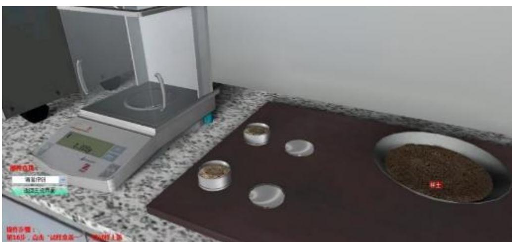
图 2-16 土的含水率（烘干法）虚拟实验（2）
