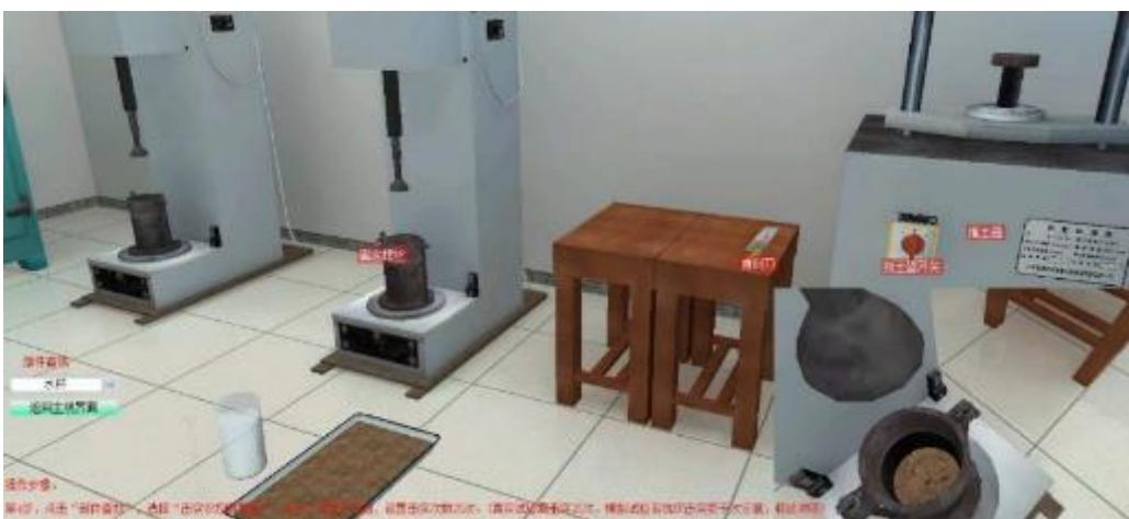
图 2-22 土的击实虚拟实验 (2)
