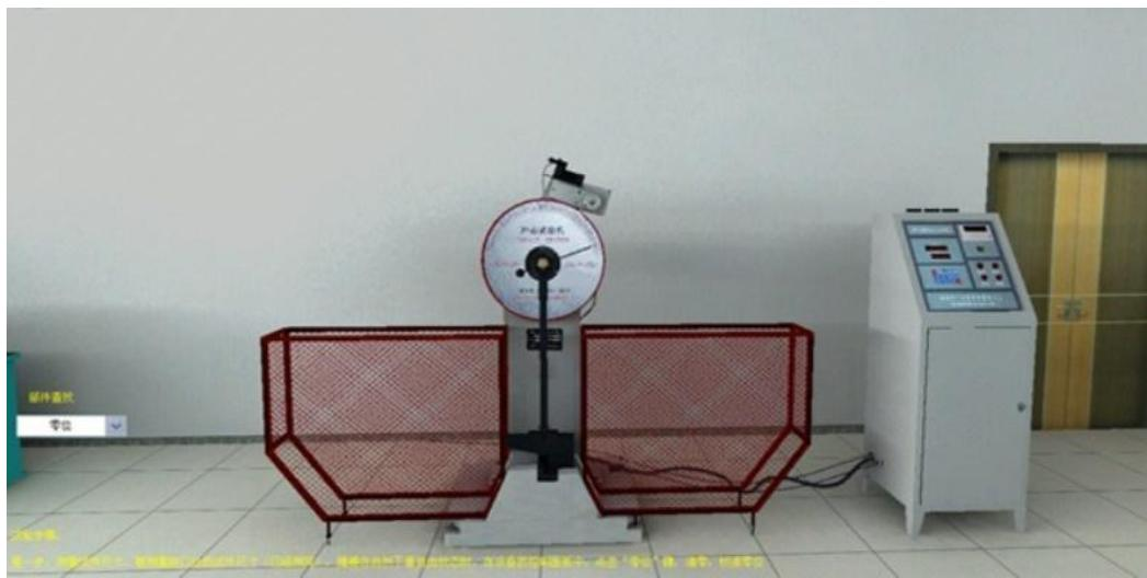
图 2-6 低碳钢和铸铁的冲击虚拟实验
