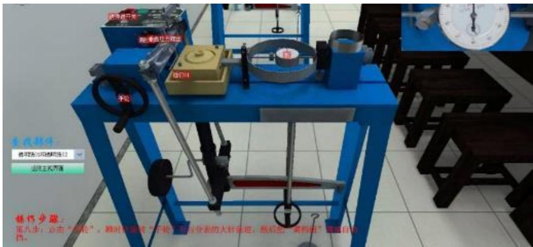
图 2 - 20 土的直接剪切虚拟试验（快剪）(2)
